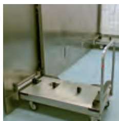
Andockung eines Übernahmewagens an den Sterilisator
