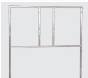
THS3508 Tisch-Hakenschiene, Edelstahl-Konstruktion, aus fugenlos verarbeiteten 25 x 25 mm Vierkantröhren; 2 x 2 Hakenpaare im Abstand von 350 mm.
