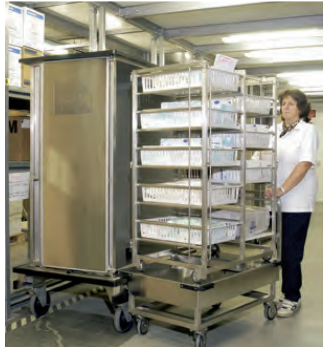
FTS-Transportwagen bei der Bestückung im Zentrallager mit dem Hammerlit-Shuttle-System kombiniert. Fotoaufnahmen aus der Uniklinik Leipzig.
