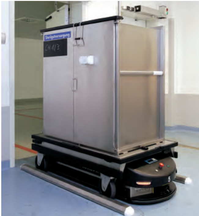
FTS-Transportwagen wird vollautomatisch abgeholt
