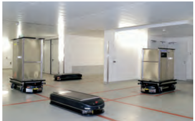
FTS-Transporteinheiten fahren selbstständig zum Ziel
