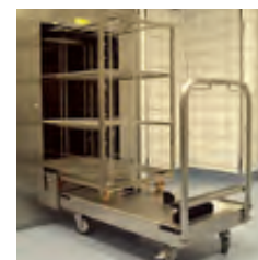
Einfahren eines 2-Wege-Einschubgestelles in den Sterilisator
